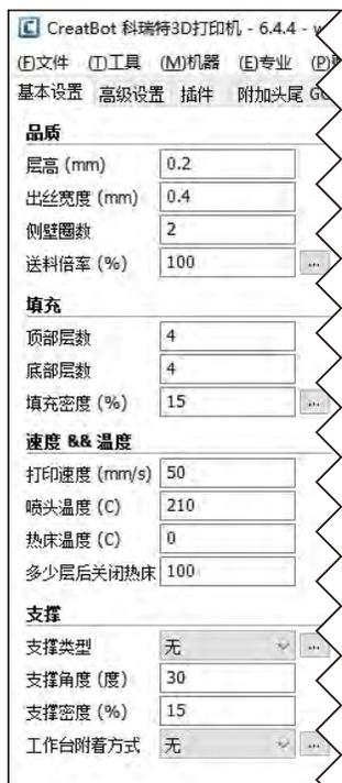
**层高:** 模型打印精度的最主要指标, 层高越小越精细, 打印时间也越长, 最大层高不超过喷嘴直径的0.8倍。
