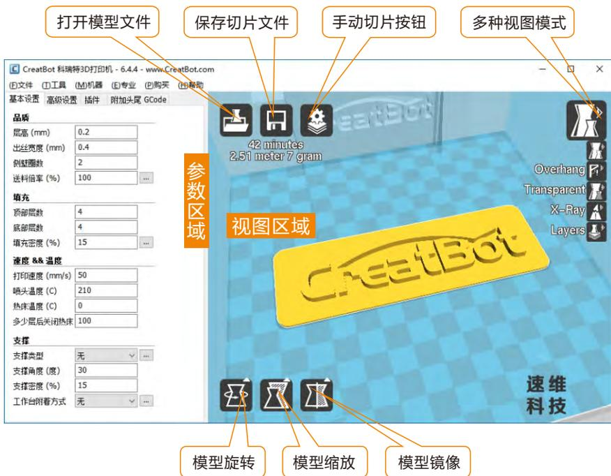
软件完整界面的左侧为参数设置区域，右侧为视图区域，参数区域分为“基本设置”，“高级设置”，“插件”，“附加头尾GCode”等4个选项卡。其中基本设置为最常用设置，平时最经常使用的参数都在这里，其它选项卡请酌情修改，如果想恢复默认设置请点击菜单“工具”>“恢复默认配置”。每一个参数都有鼠标悬停提示，大家可以根据提示进行参数设置。
