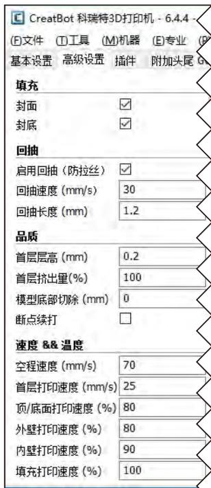
**封面**：是指是否打印模型的上面，未勾选将以填充方式打印上面。
